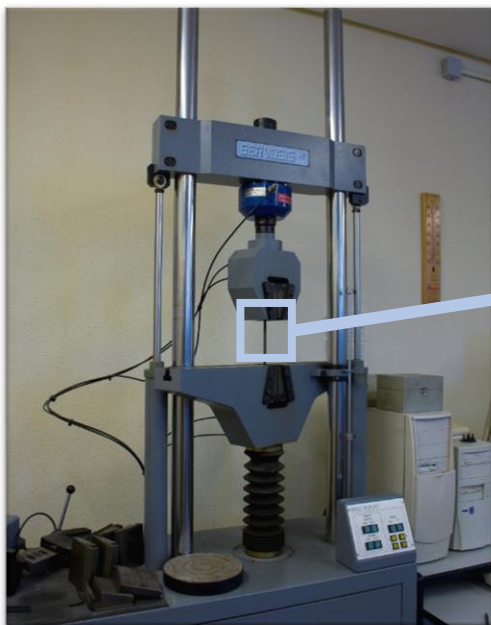
Figure 76. Máquina de prueba de tracción y muestra probada.
